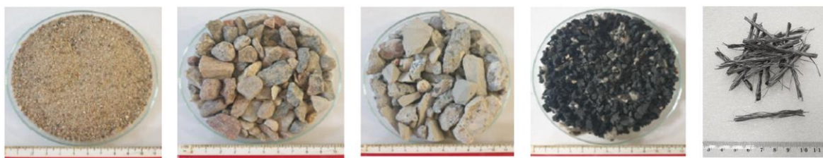
Rys. 5 – Składniki betonu (od lewej): piasek drobny (0/2 mm), naturalny żwir (8/16 mm), kruszywo z recyklingu gruzu betonowego (2/31,5 mm), granulat gumy z recyklingu opon samochodowych (2/5 mm), włókna polimerowe (długość 54 mm).
