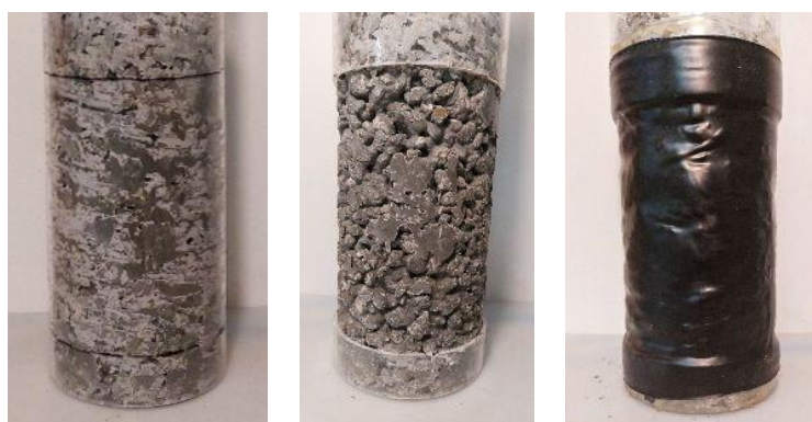
Rys. 31 – Przygotowanie próbek do badania filtracji (od lewej): mieszanka odlana do formy akrylowej, próbka po demontażu rury akrylowej, próbka uszczelniona rurą termokurczliwą RTDS-175/50.
