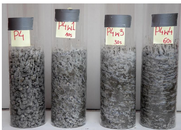
Rys. 29 – Seria próbek mieszanki betonu P4 w rurach akrylowych (od lewej): bez wibracji (P4), zagęszczanych za pomocą wibracji – 10 s (P4w1), 30 s (P4w3) i 60 sekund (P4w4).
