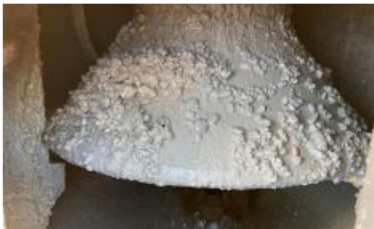
Rys. 53 – Stożek zamykający wewnątrz śluzy DLS po próbach – adhezja mieszanki.
