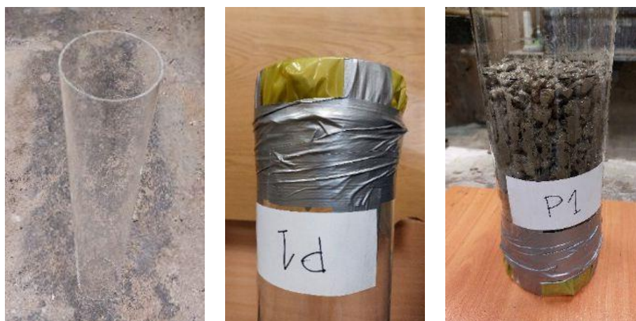
Rys. 17 – Przygotowanie próbek do badania wodoprzepuszczalności (od lewej): rura akrylowa (odcinek 1 m), uszczelnienie dna rury zapobiegające wyciekaniu betonu, mieszanka betonowa odlana do formy akrylowej.
