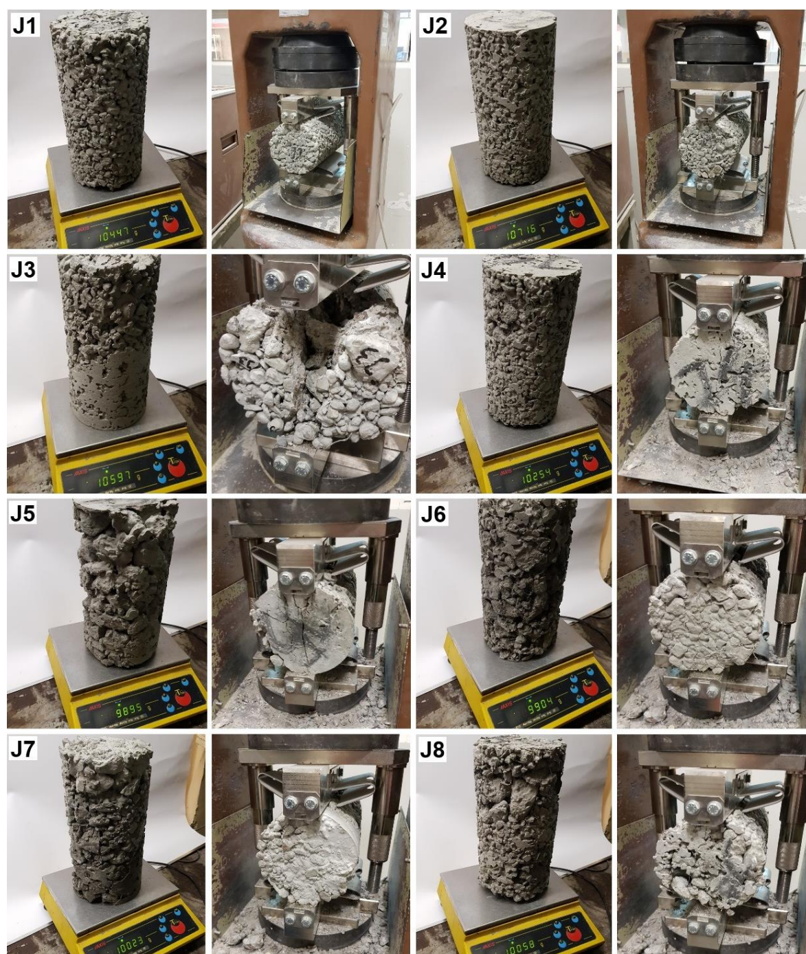
Rys. 12 – Próbkę cylindryczne poddane badaniu wytrzymałości na rozciąganie przy rozłupywaniu.
