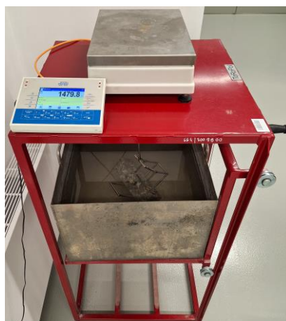
Rys. 15 – Stanowisko do ważenia za pomocą wagi hydrostatycznej.
