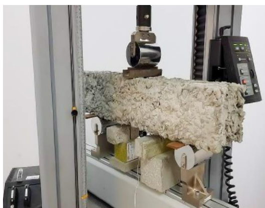
Rys. 14 – Badanie wytrzymałości na zginanie w urządzeniu INSTRON i schemat badania.
