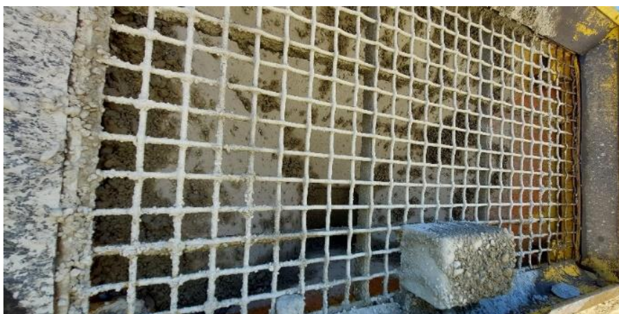
Rys. 54 – Wnętrze kubła transportowego po próbach terenowych – ślady przywierania mieszanki.
